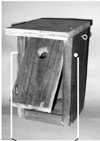
La pared frontal será basculante. Para ello haremos a ambos lados unas perforaciones algo más anchas que la puntilla que luego por este agujerito clavaremos en la madera, que así quedará suelta para bascular
