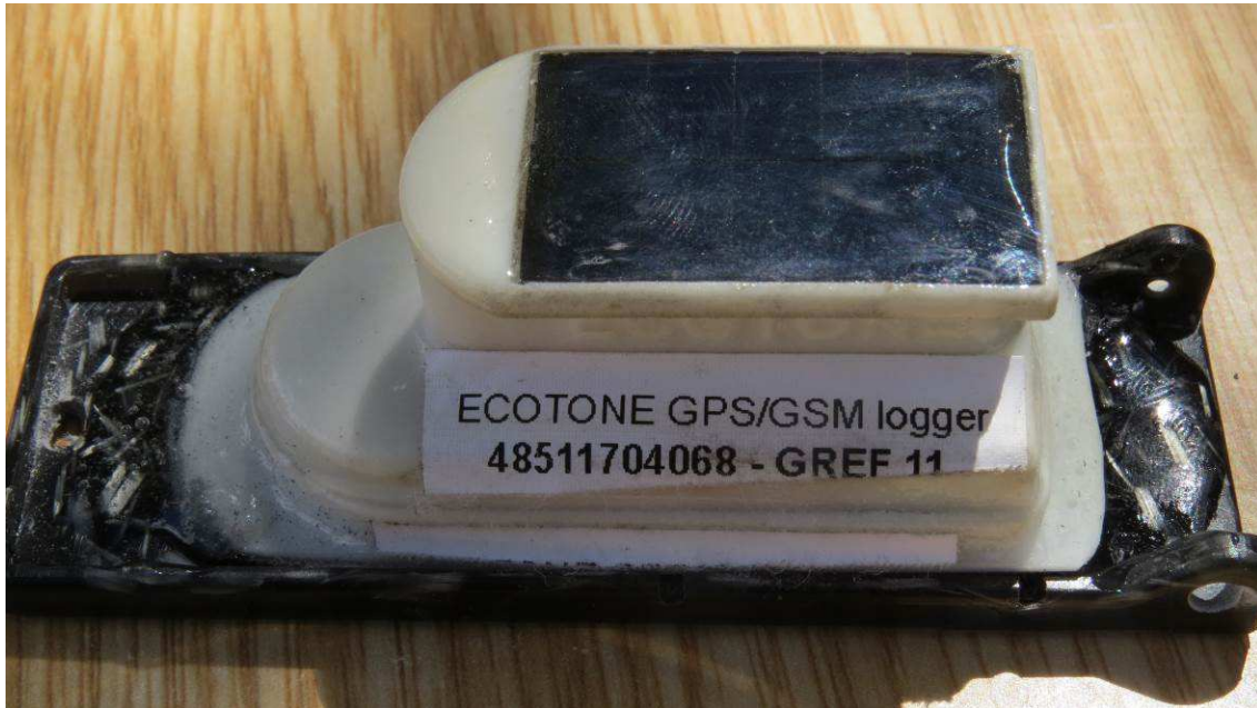
Imagen 19. Detalle de uno de los emisores GPS-GSM utilizados en 2014. Autor: Gerard Plana
