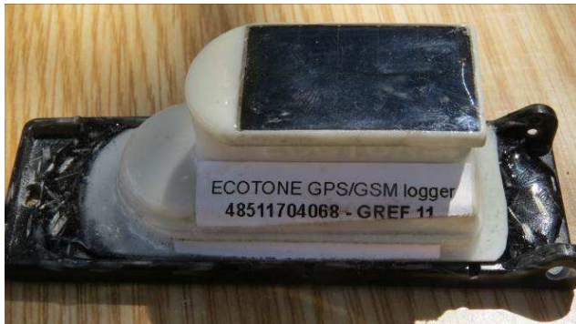
Fotografia n. 19. Detall d'un dels emissors GPS-GSM utilitzats el 2014. (Autor: Gerard Plana)
