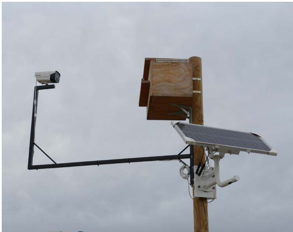
Sistema de videograbación en directo de una de las cajas nido del proyecto topillo
